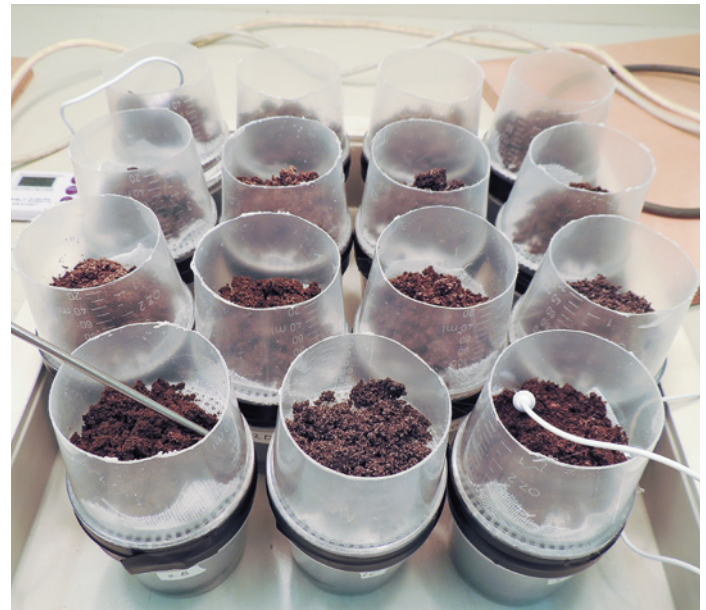
5. Hitte-extractie van oribatide mijten ( Oppia nitens ) uit de grond van een toxiciteitstest. De extractieopzet bestaat uit een bovendeel dat voorzien is van een gazen bodem en is geplaatst op een opvangbeker. Nadat de grond uit een testcontainer is overgebracht in de extractieopzet wordt deze onder een lamp geplaatst. Na ongeveer 48 uur kunnen de overlevende volwassen dieren en de geproduceerde juvenielen in de opvangbeker worden geteld. Foto: Rudo Verweij 5. Heat extraction of oribatid mites ( Oppia nitens ) from a toxicity test. The extraction device consists of an upper part with a gauze bottom that is placed on a collecting device. After transferring the test soil from a toxicity test into it, the extraction device is placed under a light source. After approximately 48 hours, all surviving adults and the juveniles produced can be counted in the collecting device.
